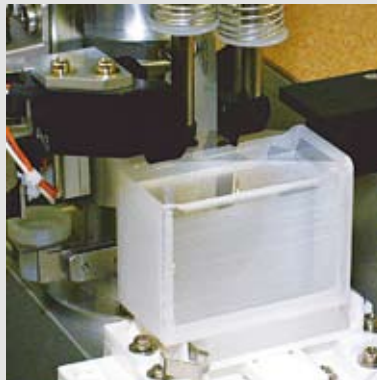
1. Ein Deckglas wird aus dem Vorratsbehälter aufgenommen
